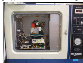
図6 ジャイロセンサキャリブレーション
